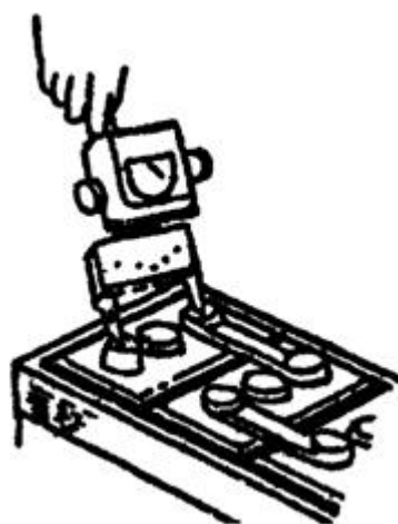
Рис. 11.15. Проверка напряжения аккумуляторной батареи под нагрузкой.
