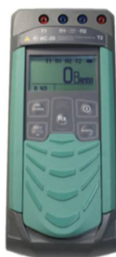
Рис. 2 Внешний вид ис-10 измеритель сопротивления заземления
