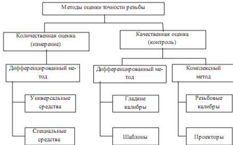
Рис. 2. Классификация методов оценки точности резьбы.
