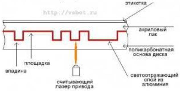
DVD (Digital Versatile Disc, универсальный цифровой диск) устроен аналогичным образом, но шаг канавки у него меньше (0,7 мкм), длина и высота выступов также меньше. Поэтому при одинаковом диаметре диска на него можно записать больше информации.
